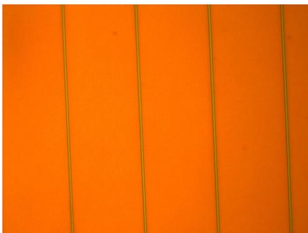
Abbildung 3.15: Mikroskopaufnahme direkt nach der Entwicklung. Die hellen Strukturen sind Gräben im PMMA. Ihr jeweiliger Abstand beträgt in diesem Bild  $50\ \mu\text{m}$ .
