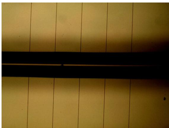
Abbildung 3.26: Mikroskopaufnahme einer geeigneten Maske aus CRYSTALBOND (schwarzer Streifen im Bild). Der Abstand der Wellenleiter beträgt  $250\ \mu\text{m}$ .
