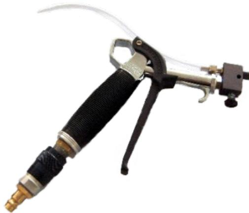
Abbildung 6.1: Endkopf und Düse des Mini-Hochdruckreinigers LICOJET. Durch Zusammendrücken des Handgriffs wird der Arbeitsdruck variiert. Links oben ist der Anschluss für Wasser, links unten wird Stickstoff bei 8 bar angeschlossen.
