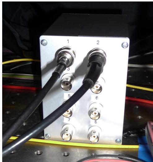
Abbildung 3.3: Multimeter mit acht Eingängen. An den Eingängen 1 und 2 sind über ein Koaxialkabel die Photodioden angeschlossen.
