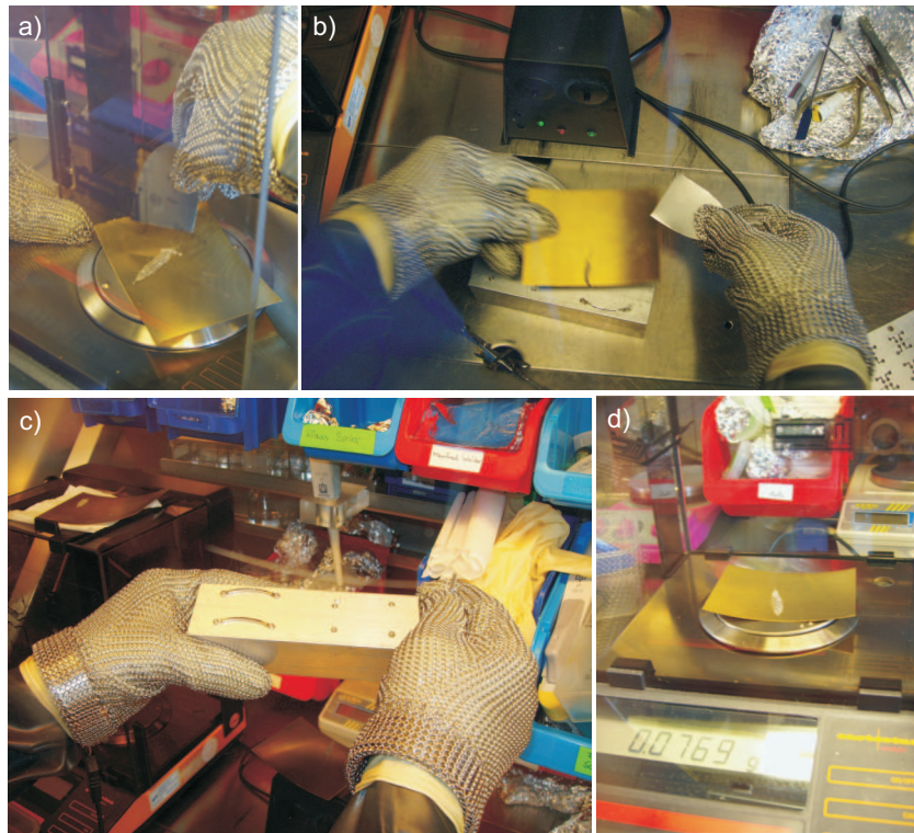
Abbildung 3.3: Abwiegen des Ausgangsmaterials und Befüllen der Dispenser. Bild a) und d) Abwiegen in der Glovebox unter Stickstoff. b) Wiederholtes Einstreichen der Redox-Mischung in die gehaltenen Dispenser, im Hintergrund der Statik-Eliminator (schwarzes Gerät). c) Befüllte Dispenser auf Aluminiumblock, vor der Integration auf den Markorring.
