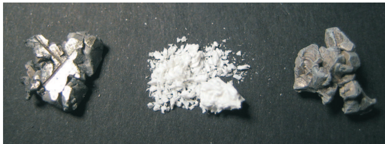
Abbildung 3.1: Drei Kalzium-Brocken. Links frisch angefeilt, metallisch glänzendes Kalzium, in der Mitte ein der atmosphärischen Luft etwa eine Woche ausgesetzter Brocken, der bereits zu Pulver zerfällt. Rechts einer der Brocken, die in der Glovebox-Atmosphäre verarbeitet und dann unter Vakuum etwa 9 Monate aufbewahrt wurden. Alle drei Stücke sind jeweils etwa 1 cm groß.
